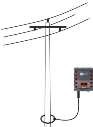
Rys.9. Praca przyrządu przy użyciu pojedynczych cęgów
